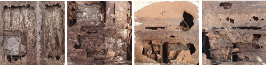
Exemple de dégradation causée par les termites Coptotermes acinaciformis sur un échantillon de bois-appât après 38 semaines d’exposition lors d’un essai de terrain en classe de risque H3.
