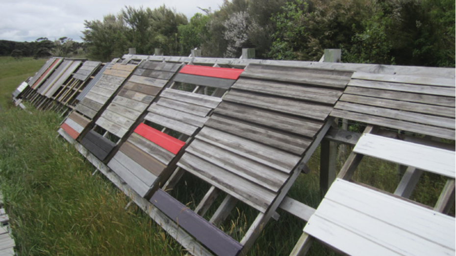
Supports d’essai pour panneaux plats, site de Māngere.
